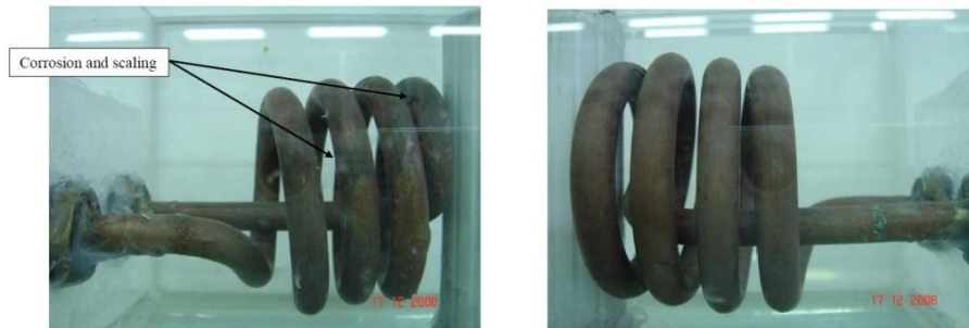
7.3. ábra Fűtőelemek vízkeringető rendszerekben (a: balra: AQUABION® nélkül és b: jobbra: AQUABION®-val) [Min, Yong (2009)].
